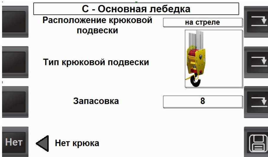
Рисунок 7 – Экран конфигурации основной лебедки
